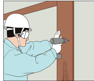
※インパクトドライバーは製品の破損の原因となります。電動ドライバーを使用してください。
