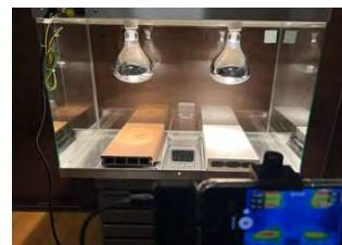
木粉樹脂材と彩木材に150℃の熱源を2時間当て続け、サーモグラフィーで記録し、蓄熱量の違いを比較する実験
